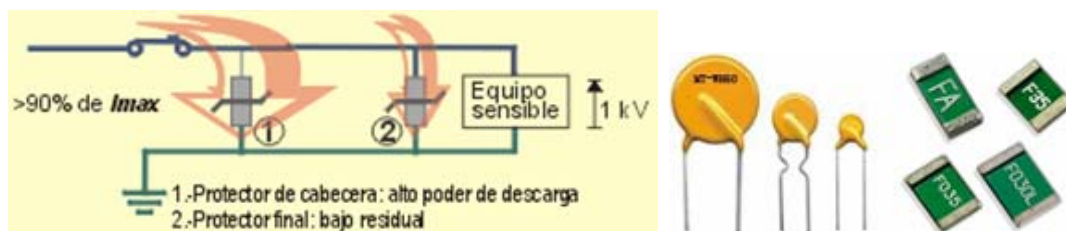
Figura 11. Aplicació típica d'un varistor. Encapsulat normal i SMD.
