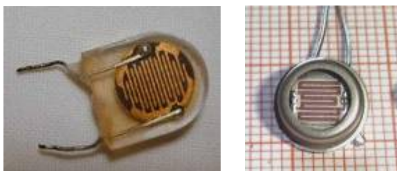
Figura 8. LDR (Light Dependent Resistor, o resistència que depèn de la llum).
